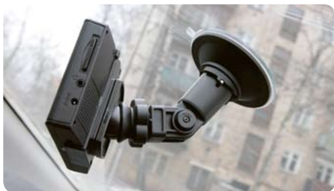
RoskeNavigato: карта памяти излишне выступает из слота, что грозит несанкционированным «отщёлкиванием». Вращающаяся полусфера удобна в регулировке, но пружины фиксатора присоски и «колена» кронштейна избыточно тугие.
